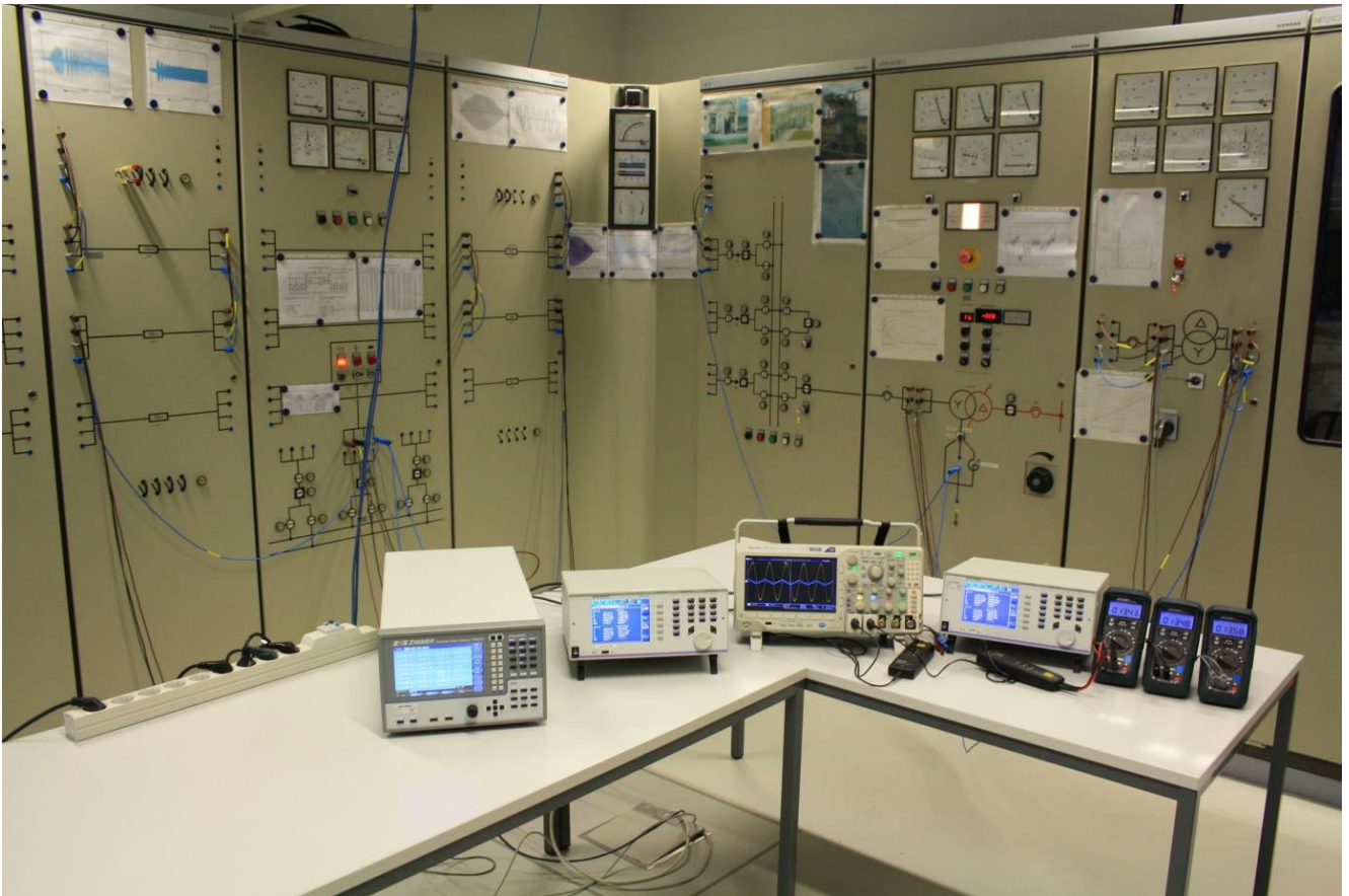
Abbildung 1: Versuchsaufbau zur Leistungsflusssteuerung beim Parallelbetrieb von Leitungen
